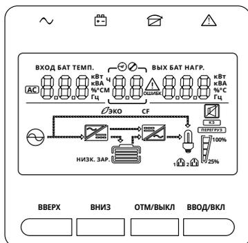
Рисунок 6.1. Панель управления ИБП
